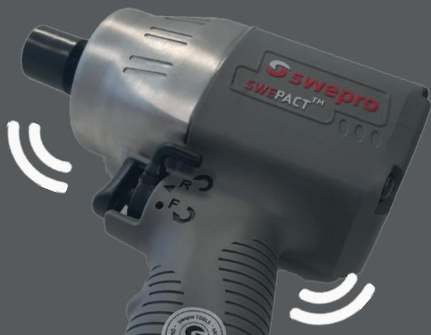
La serie di avvitatori industriali SWEPACT™ ha vibrazioni fino al 40% in meno. Tra il motore a palette e l'unità di impatto SWEPACT™ è presente uno speciale cuscinetto a molla con un perno di guida al centro. Questo pin consente la trasmissione di potenza concentrica tra il motore e l'unità di impatto. La nuova concezione dello speciale cuscinetto a molla e la trasmissione di potenza concentrica via pin riducono la trasmissione di vibrazioni dall'unità di impatto all'incudine ed all'utente.
